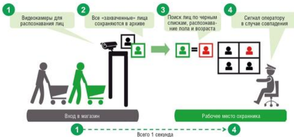
Рисунок 3 – Схема работы видеокамеры для распознавания лиц
