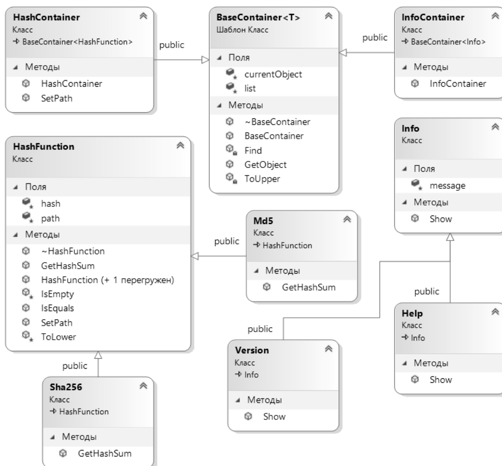
Рисунок 1 – Упрощённая диаграмма классов разработанного программного средства
